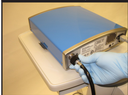
Figura 3: Collegamento del condotto dell'aria dello strumento/dell'azoto
