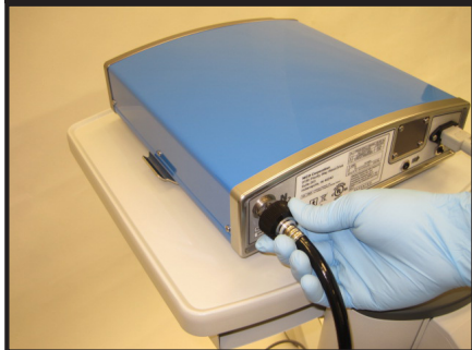
Figure 3 : Connexion de la ligne d'azote/d'air régulé
