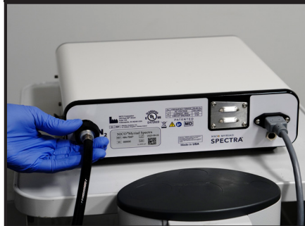
Figure 4 : Connexion de la ligne d'azote/d'air régulé
