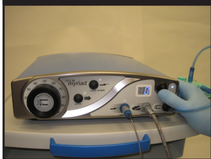
Figure 15 : Mise sous tension de la console
