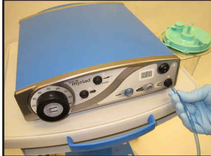
Figure 3 : Connexion de la ligne d'aspiration
