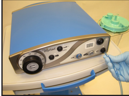
Figura 3: Collegamento del condotto di aspirazione
