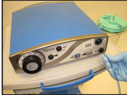
Figura 3: Conexión del conducto de aspiración
