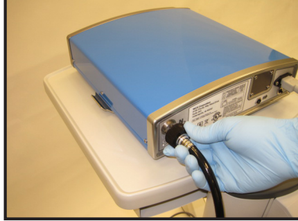
Figura 2: Conexión del conducto de nitrógeno/aire del instrumento
