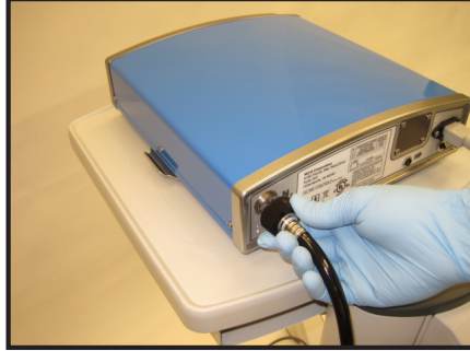
Figura 2: Ligação da Linha de Ar do Instrumento/Nitrogénio
