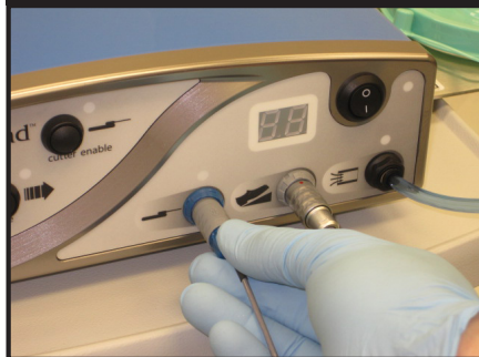
Figura 6: Collegamento del manipolo alla console
