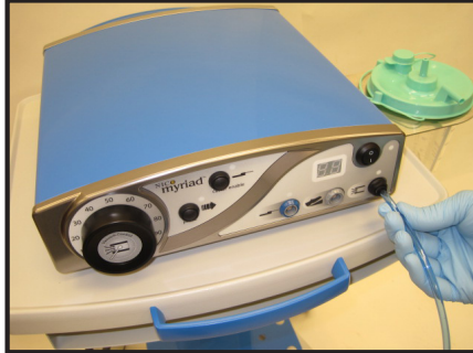
Figura 3: Collegamento del condotto di aspirazione
