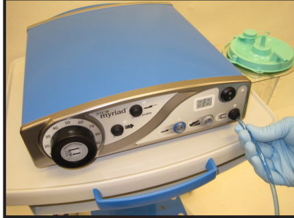
Figura 3: Conexión del conducto de aspiración
