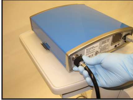
Figura 2: Collegamento del condotto dell'aria dello strumento/dell'azoto
