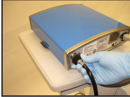
Abbildung 2: Anschluss für Stickstoff-/ Instrumentenluftleitung
