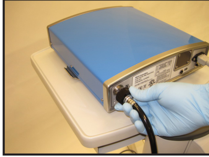
Figura 2: Ligação da Linha de Ar do Instrumento/Nitrogénio
