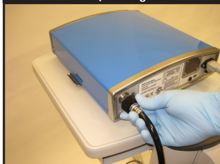
Figure 2 : Connexion de la ligne d'azote/d'air régulé
