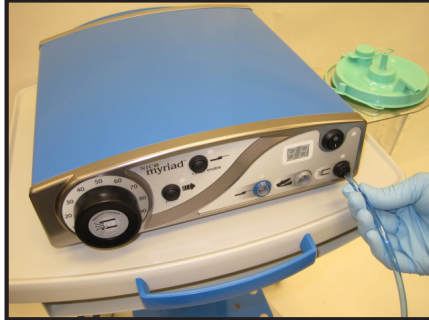
Figura 3: Collegamento del condotto di aspirazione
