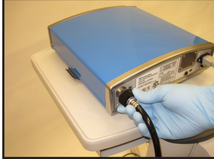
Figure 2 : Connexion de la ligne d'azote/d'air régulé
