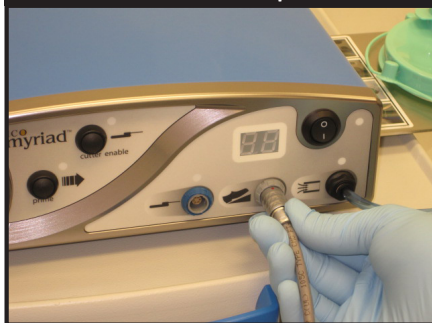
Figura 5: Collegamento dell'interruttore a pedale
