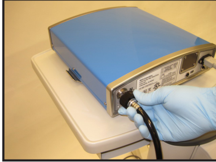
Figura 2: Collegamento del condotto dell'aria dello strumento/dell'azoto
