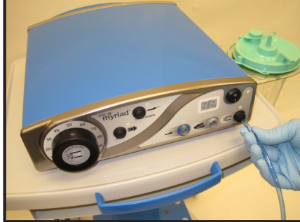
Figure 3 : Connexion de la ligne d'aspiration
