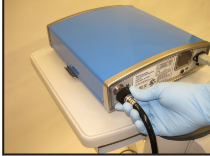
Figura 2: Conexión del conducto de nitrógeno/aire del instrumento
