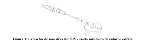
Figura 3: Extractor de muestras (sin SIV) usado solo fuera de entorno estéril
