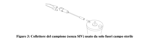
Figura 3: Collettore del campione (senza SIV) usato da solo fuori campo sterile
